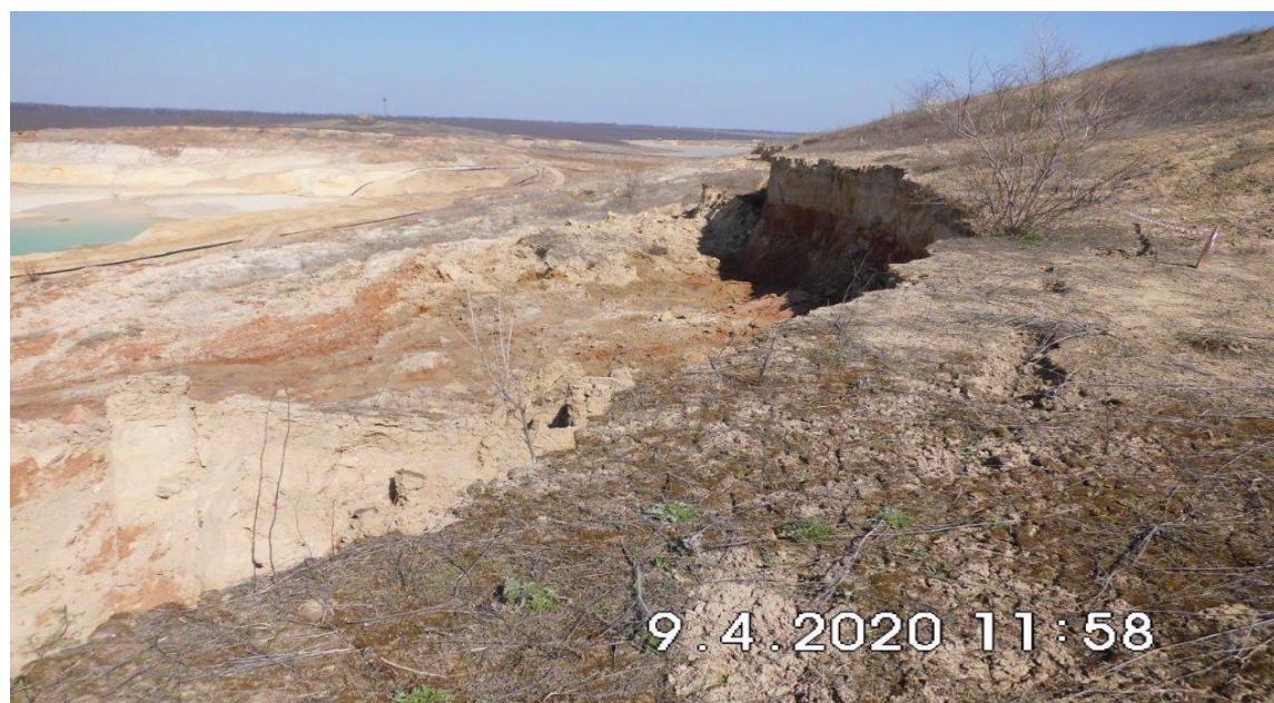
Рис. 4.9. Вершина зсуву в кар'єрі Мотронівського ГЗК з бровкою зриву уступу
