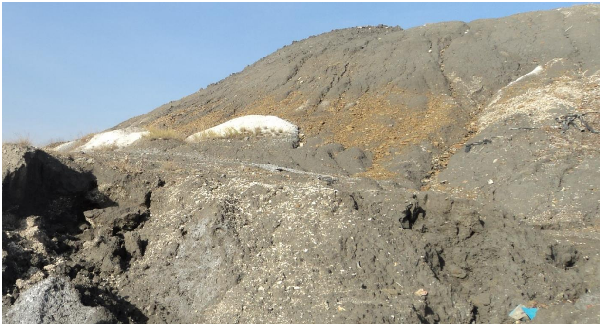
Рис. 8.26. Зовнішній відвал Домбровського кар'єру. Світлий колір – відкладення мірабіліту в місцях виливу розсолів.
