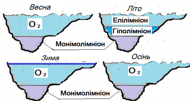
Рис. 1.12. Схема сезонної стратифікації і рециркуляції водної товщі в мероміктичних озерах. За R. Gulati, E. Zadereev [50]
