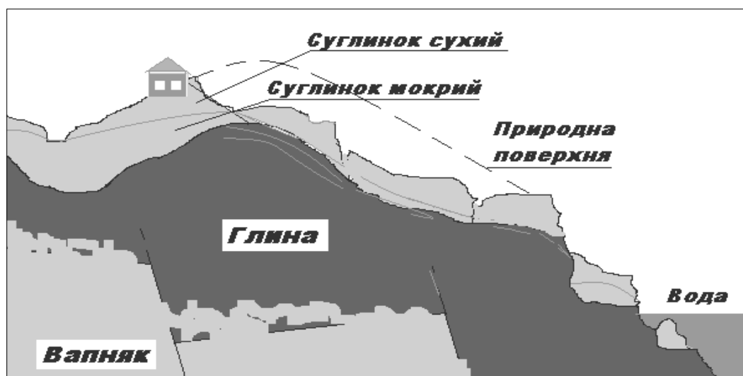
Рис. 4.4. Схема, що пояснює причину і механізм зсуву четвертинних відкладень по нахиленій поверхні неогенових глин. Межа зсуву – вододіл у покрівлі неогенових відкладів
