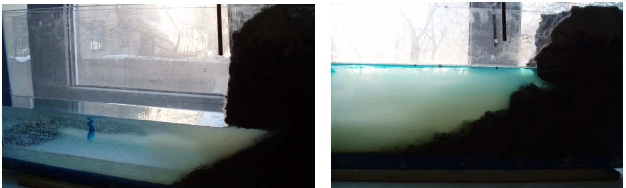
Рис. 4.12. Підрізання і обвалення борту внаслідок розчинення соленосних порід (модель)
